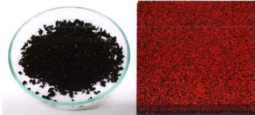
Abbildung: Gummigranulat (links) und PU-ummantelte Gummiplatte (rechts)
