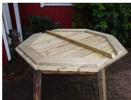
Bordsskivan ligger upp och ner, färdig för att påbörja monteringen.
