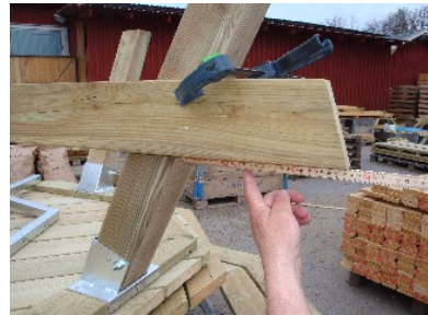
Kontroller att du har rätt avstånd mellan benet och bärlinans slut skall vara 28 cm på samtliga sidor.
