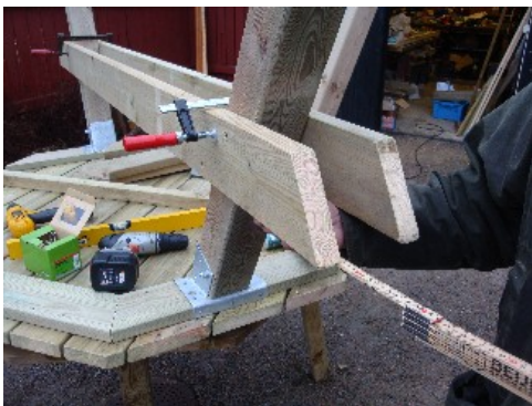
Fixera med skruvtving och kontroller höjdmåtten samt avståndsmåtten på vardera sida. Fäst därefter med skruv.
