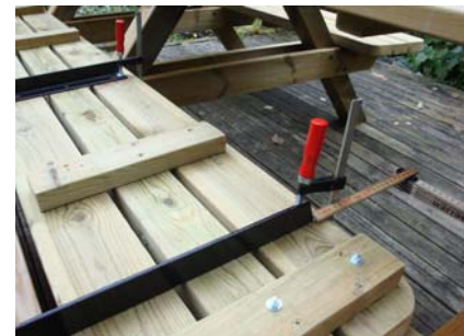
Kontrollera att du har samma avstånd på båda sidor.
