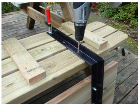
Borra i ryggstödet förborrade hål.
