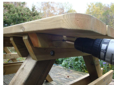
Montera med 3 st. trallskruv i bordets knaper och benpar.
