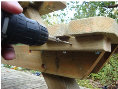
Fäst varje sits med 3 st. trallskruv vardera sida.
